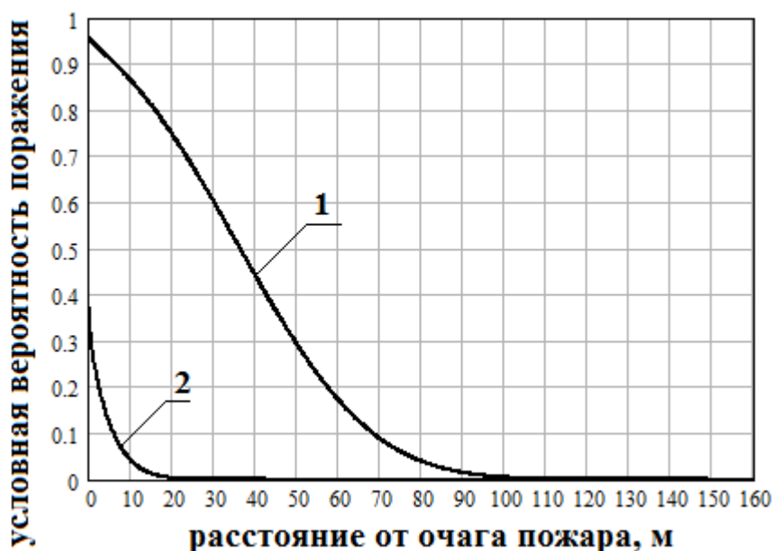
Рис. 3.2.10. Зависимости условных вероятностей поражения человека тепловым излучением от расстояния до очага пожара Q_{dIII} - кривая 1, Q_{dIV} - кривая 2
