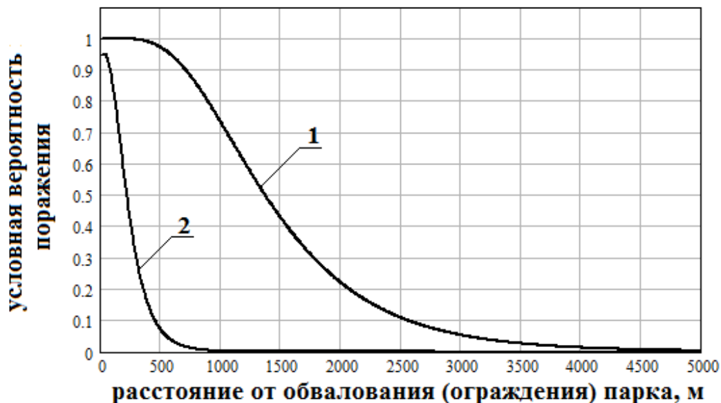
Рис. 3.2.11. Зависимости условных вероятностей поражения человека волной давления от расстояния до обвалования (ограждения) парка Q_{dVIII} - кривая 1, Q_{dVII} - кривая 2
