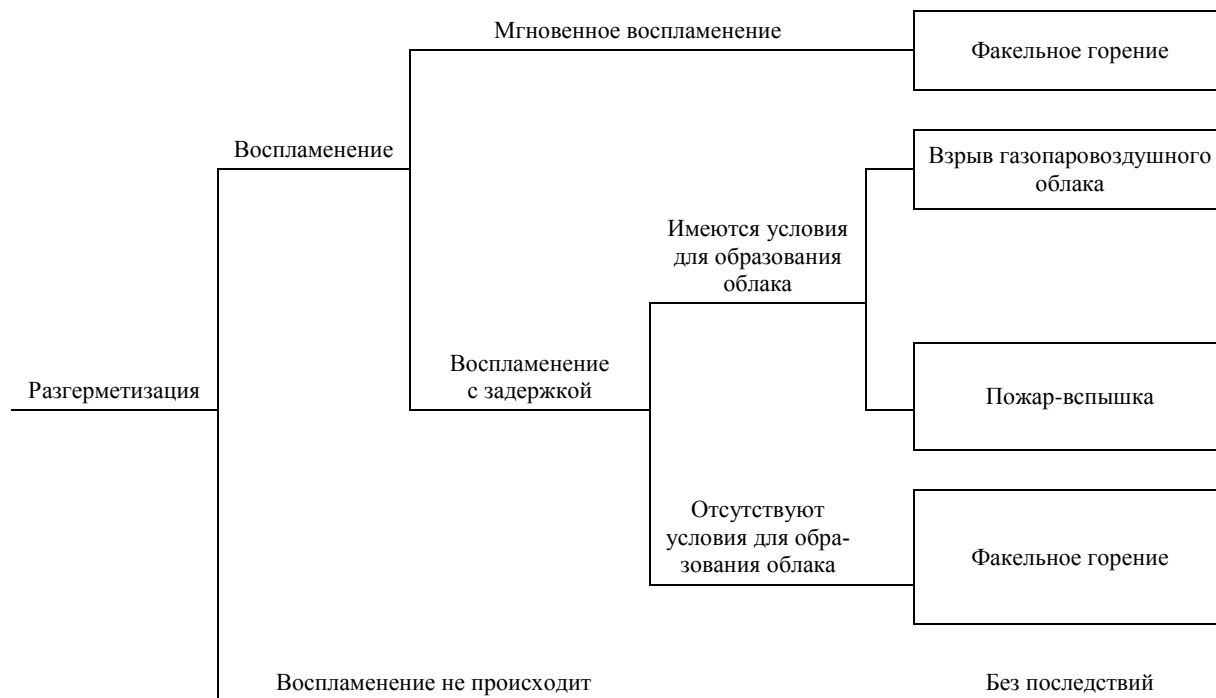
Рис. ПЗ.3. Типовое дерево событий при возникновении и развитии пожароопасной ситуации, связанной с разгерметизацией единицы технологического оборудования (1-го аппарата) и истечением ГГ или паров ЛВЖ
