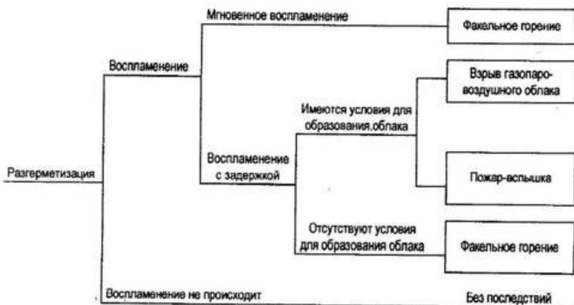
*Рис. П3.3. Типовое дерево событий при возникновении и развитии пожароопасной ситуации, связанной с разгерметизацией единицы технологического оборудования (1-го аппарата) и истечением ГГ или паров ЛВЖ*
