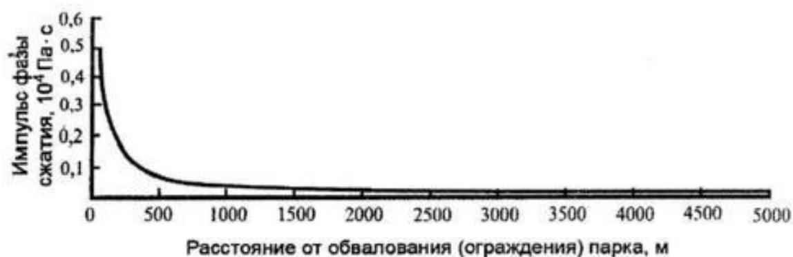
Рис. 3.2.11. Зависимость импульса фазы сжатия в волне давления от расстояния до обвалования (ограждения) парка (масса паров  $9677$  кг)
