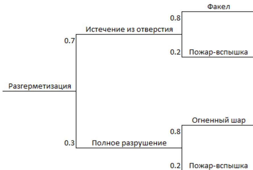
Рис. 3.8.1. Дерево событий при возникновении и развитии пожароопасной ситуации, связанной с разгерметизацией автомобильной цистерны с СУГ
