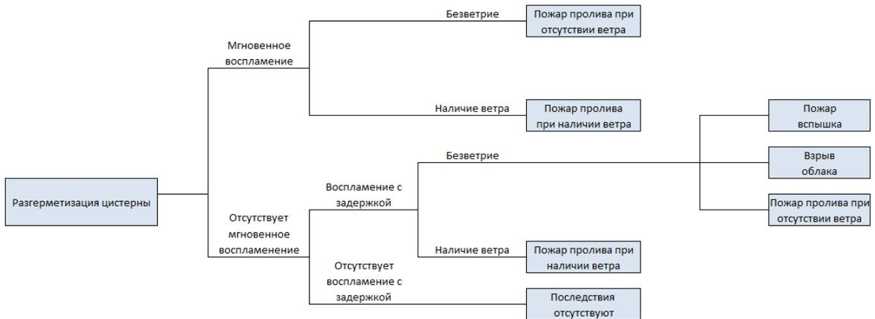
**Рис. 3.7.1. Дерево событий при возникновении и развитии пожароопасной ситуации, связанной с разгерметизацией железнодорожного вагона-цистерны с ЛВЖ**
