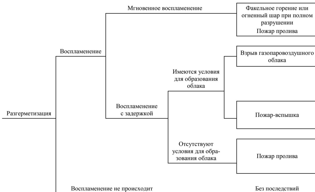
**Рис. ПЗ.2. Типовое дерево событий при возникновении и развитии пожароопасной ситуации, связанной с разгерметизацией единицы технологического оборудования (1-го аппарата) и истечением жидкой фазы или двухфазной смеси СУГ или ЛВЖ**
