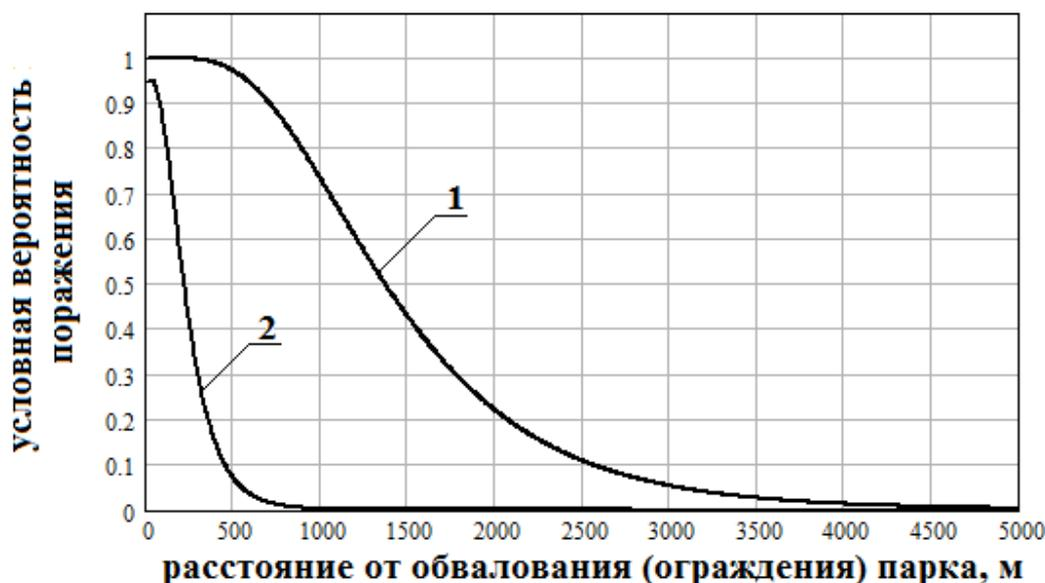
**Рис. 3.2.11. Зависимости условных вероятностей поражения человека волной давления от расстояния до обвалования (ограждения) парка**
