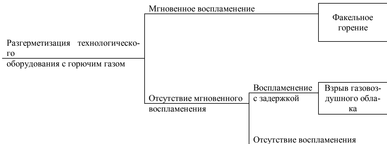
Рис. 3.6.2. Дерево событий при возникновении и развитии пожароопасных ситуаций и пожаров, связанных с разгерметизацией технологического оборудования с горючими газами, а также подводящих/отводящих к оборудованию трубопроводов в помещении
